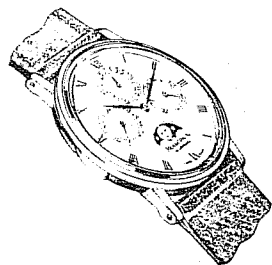
Rys. 11.24. Zegarek naręczny z repetierem minutowym, naciągiem automatycznym i wiecznym kalendarzem
