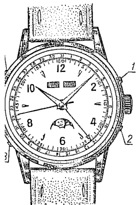
rys. 9.18. Nastawianie wskazań zegarka kalendarzowego za pomocą korektorów
