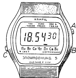
Rys. 7.78. Zegarek ELEKTRONIKA 30353 z trzema przyciskami: A — do korekcji wskazań czasu i kalendarza, B — do wybierania poszczególnych wskazań, C — do podświetlania
