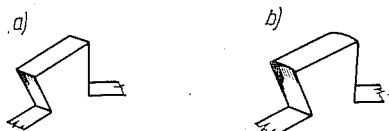
Rys. 115. Wygładzone zęby koła wychwyty kółkowego: a) płasko, b) półokrągło
