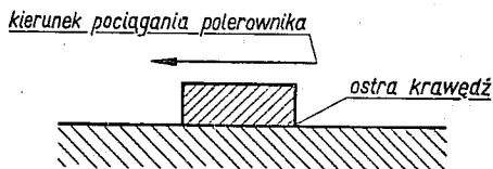
Rys. 272. Zasada ostrzenia polerownika
