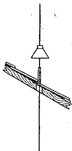
Rys. 152. Zabezpieczenie otworu do cięgna wychodzącego ponad dach
