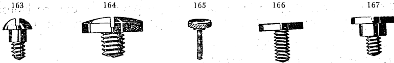
Rys. 163. Wkrętka zaciskowa (Klemmschraube). Rys. 164. Wkrętka używana przy większych mechanizmach. Rys. 165. Inny rodzaj śrubki ściennej. Rys. 166. Wkrętka kółka naciągowego z lewym gwintem (Aufzugschraube mit linkes Gewind). Rys. 167. Wkrętka kółka naciągowego z nasadką (Aufzugschraube mit Ansatz).
